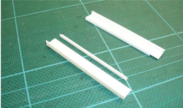
Dieses Doppelprofil wird als Eckverstärkung verwendet, wobei die kleinste Seite von dem größten Profil auf die Stirnseite geklebt wird, weil das kleinste Profil als Türrahmen eingesetzt wird.
