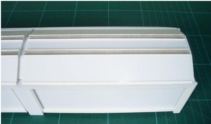
Zwischen die Laufgitter wird, in der Mitte die Schiebedach-Verriegelung in Draht montiert.
